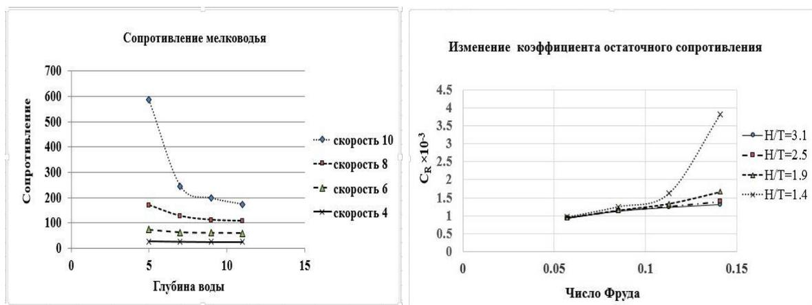
Рисунок 5 – Сопротивление на мелководье для судна типа «река-море»
