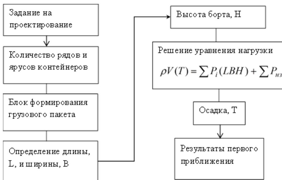
Рисунок 6 – Алгоритм определения главных размерений судов
