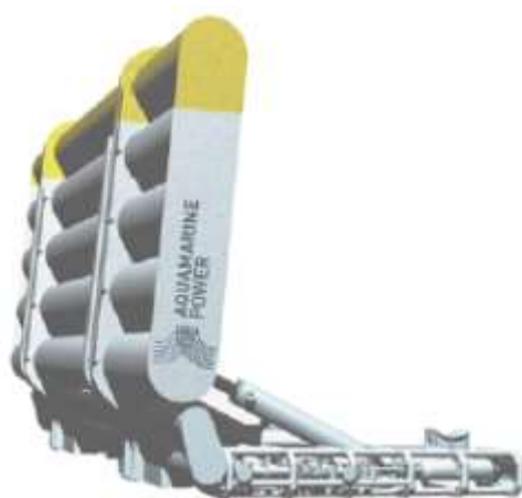
Рисунок 1 - Преобразователь энергии волн с качающейся створкой
