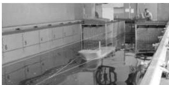
Рисунок 3 – Движение модели судна с использованием ГБС
