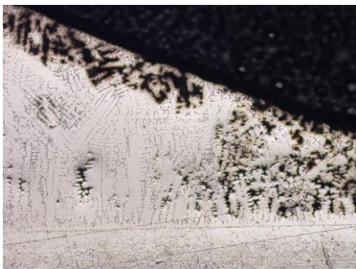
Рисунок 7 – Межкристаллитная коррозия, проникающая из припоя в структуру основного металла, x100
