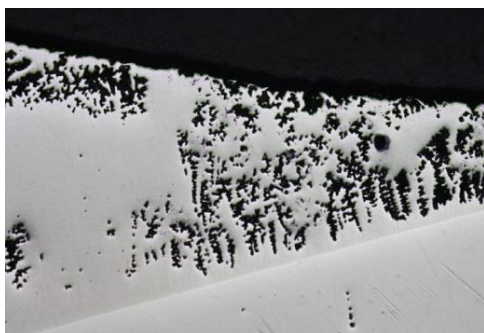
Рисунок 2 – Межкристаллитная коррозия в сварном шве, х100
