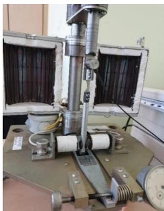
Рисунок 2 – Установка резонансного типа
