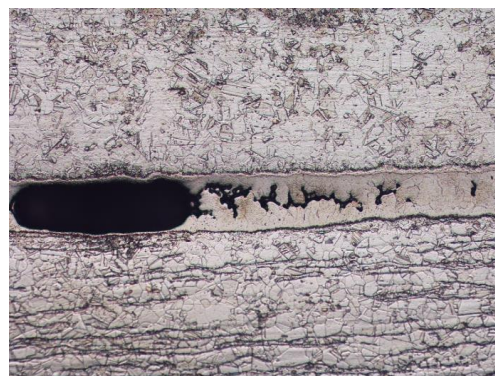
Рисунок 8 – Пора в зоне сварного шва, межкристаллитная коррозия в зоне припоя, x400
