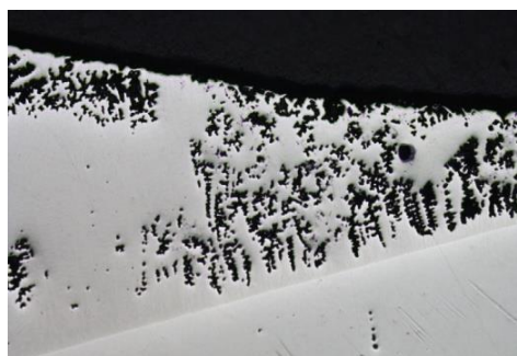
Рисунок 2 – Межкристаллитная коррозия в сварном шве, x100
