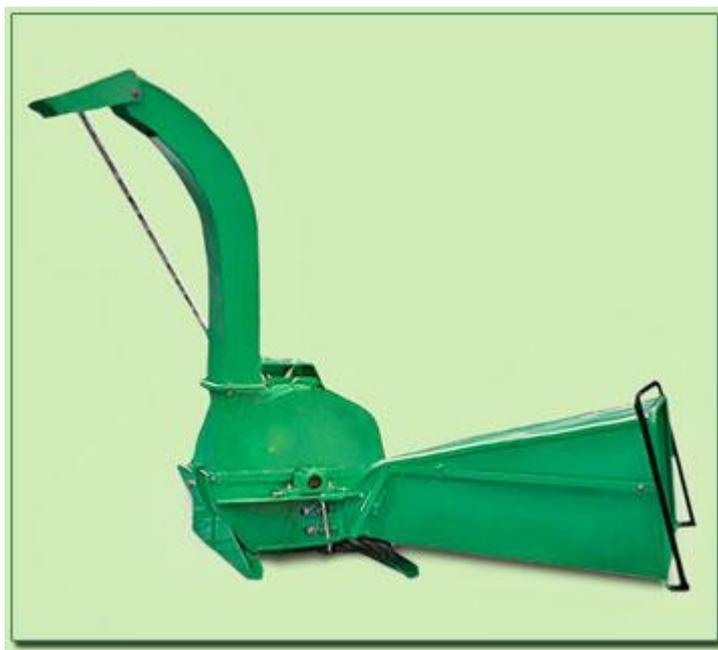
Рисунок 1.1 - Роторная рубительная машина
